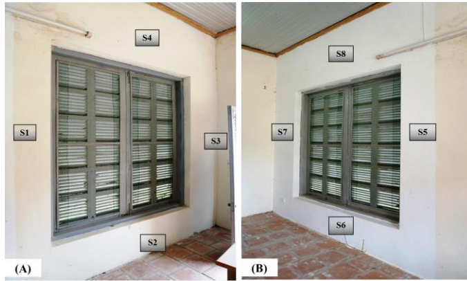
Hình 1. Các vị trí thu mẫu trên bề mặt sơn tường (A) Sơn tường đối chứng không bổ sung bioxide (B) Sơn tường thử nghiệm có bổ sung bioxide
